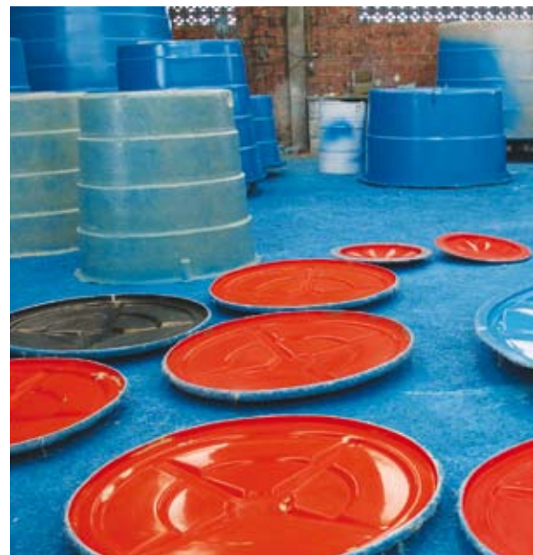
AISLANDO tapas de tanques de agua.
